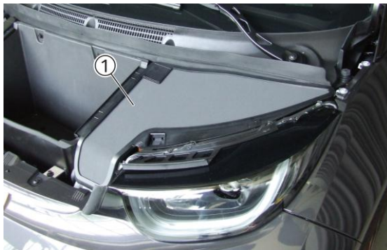
Abdeckung rechts (1) herausnehmen.
