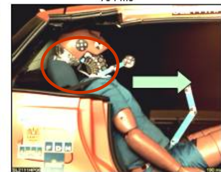
Kopfanprall am Dach beim Rebound 190 ms
