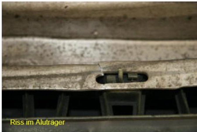
Ausgeweitetes Loch an der Aufnahme der Stoßfängerverkleidung
