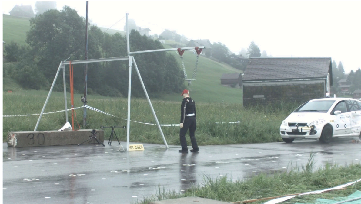
Mercedes Benz A-Klasse vs. Biofidel-Dummy 3.1 mit v_k = 72 \text{ km/h}
